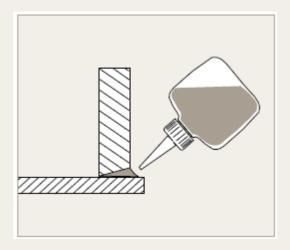
Winkelverklebung mit Leimverteiler aus PE
