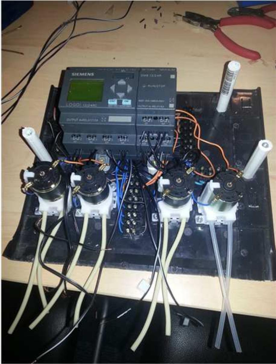
Nun wird die mittlere Platine angeschraubt und die Anschlüsse der hinteren DC-Büchsen angeschlossen.
