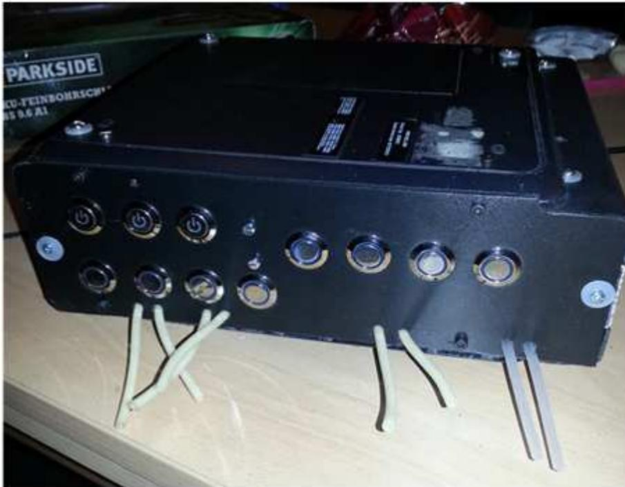
Wie man sieht habe ich mich entschlossen die Dosierpumpen im Inneren zu plazieren. Das sieht optisch deutlich besser aus als wenn die Pumpen draussen sind. Sollte einer der Schläuche defekt sein, kann die obere Platine einfach abgeschraubt werden und der Schlauch innterhalb von ein Paar Minuten ausgetauscht werden.
