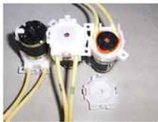
**4 Dosierpumpen zum Selbstausbau** bei ebay, Kosten etwa **32€** (momentan kosten die Pumpen etwas mehr). Die Qualität der Pumpen ist in diesem Fall kein wichtiger Punkt, da die Pumpen höchstens 1-2 min am Tag laufen werden.
