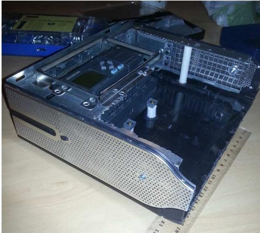
Als Nächstes wird die hintere Platine fertiggestellt. Hierzu wird die notwendige Form aus Hartschaum mit einem Messer rausgeschnitten. Hartschaum ist etwas weicher als anderes Plastik (PE oder PA), lässt sich aber einfach schneiden. Die ausgeschnittene Form sieht so aus:
