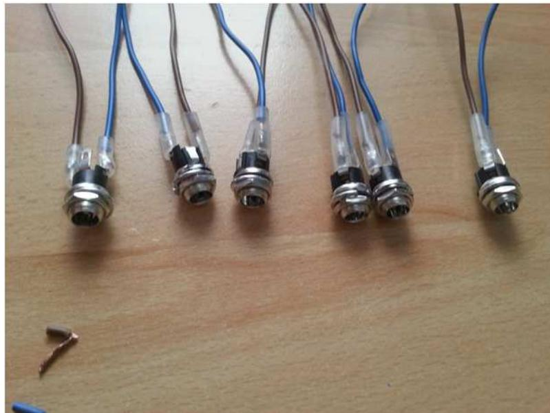
Nun werden die DC-Büchsen in die gebohrten Löcher der ausgeschnittenen Platine eingesetzt. Vorsicht beim Bohren größerer Löcher im Hartschaum. Dieser ist sehr leicht deformierbar. Am besten mit einem kleinen Bohrer anfangen und dann in kleinen Schritten auf die gewünschte Größe ausbohren.
